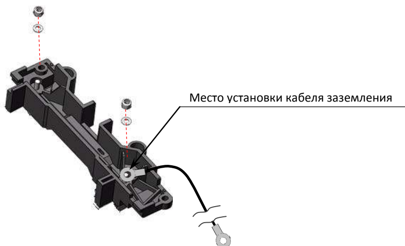
Рисунок 22. Место установки клеммы кабеля заземления с внутренней части основания ТПГ
