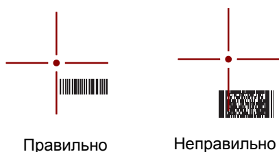
Рис. 3-5 Рамка наведения имидж-сканера: отсутствие центровки на штрихкоде
