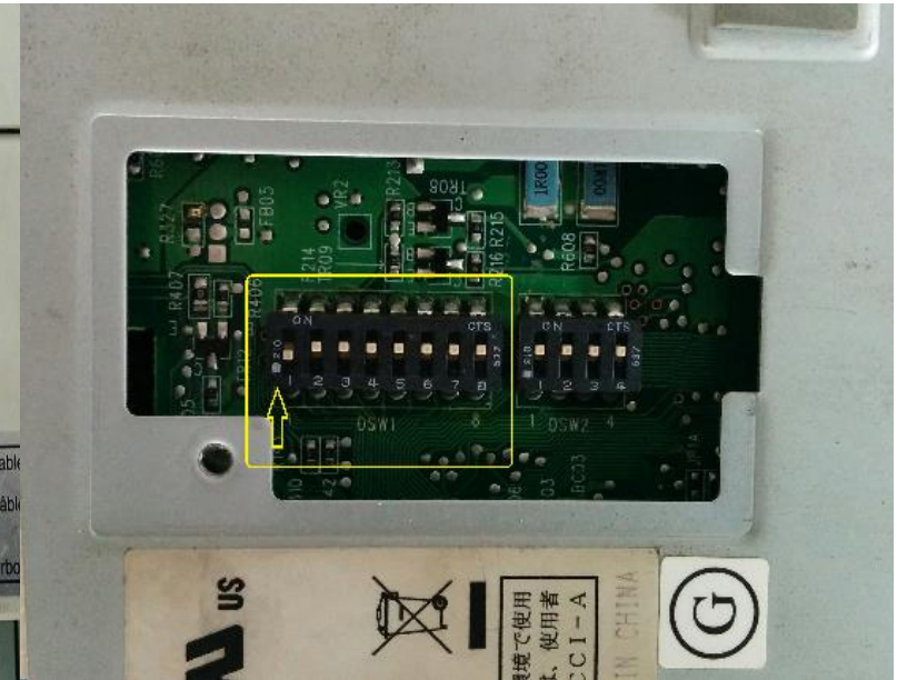
Переключатель режимов работы(крышка на дне корпуса)
