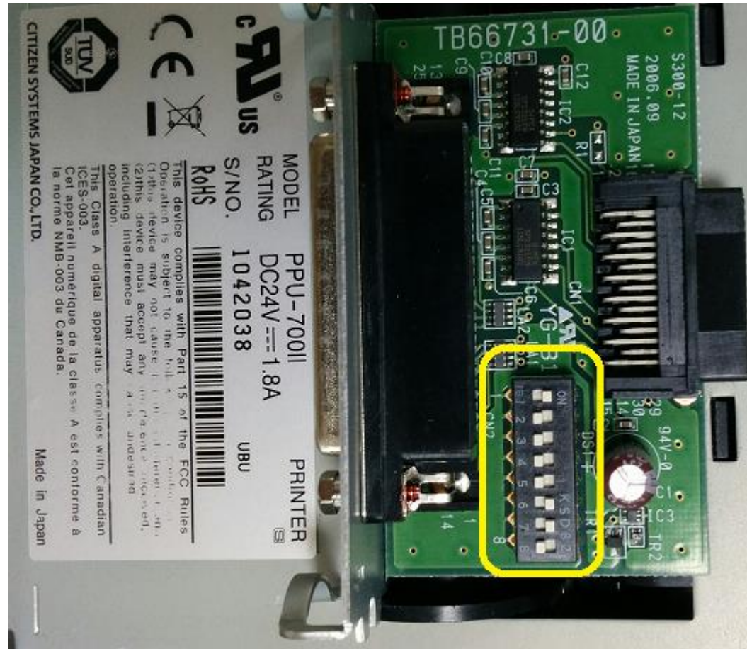
Интерфейсная плата на боковой панели платы управления
