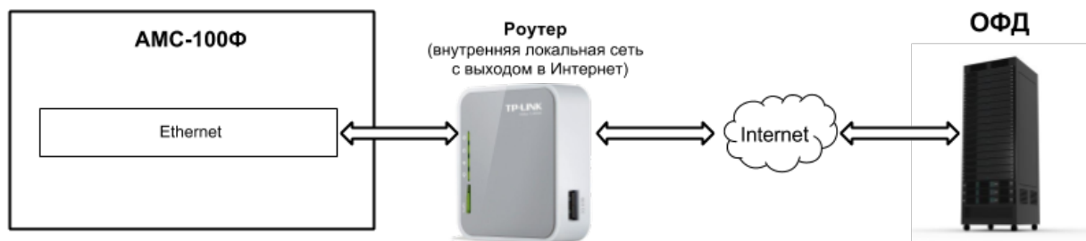
Подключение AMC-100Ф к техническим средствам ОФД при работе по интерфейсу Ethernet
