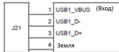
Рисунок 27. Назначение и функции контактов USB разъема.
