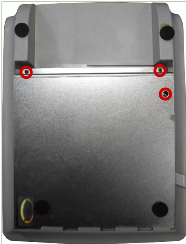
4. Снять нижнюю крышку корпуса, открутить три винта на блоке управления.
