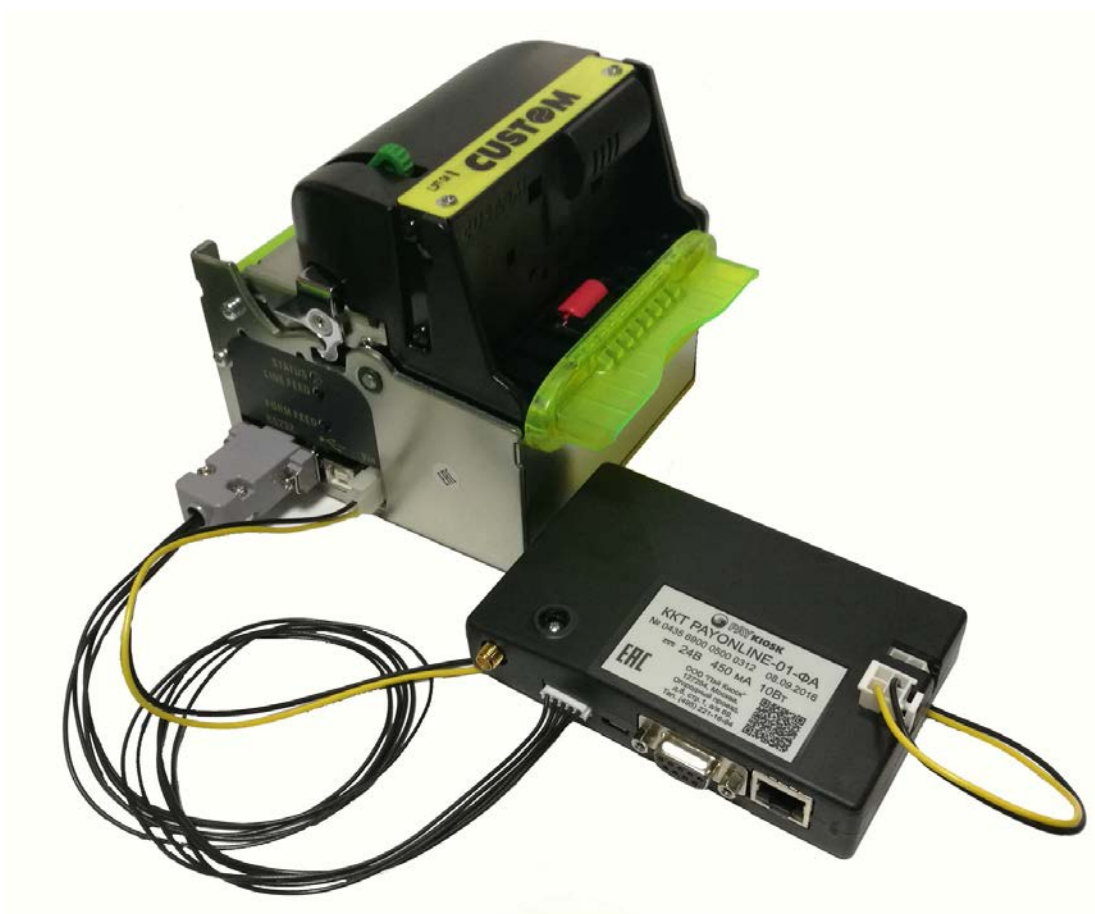
Рисунок 29. Подключение ПУ к ККТ на примере Custom VKP-80II
